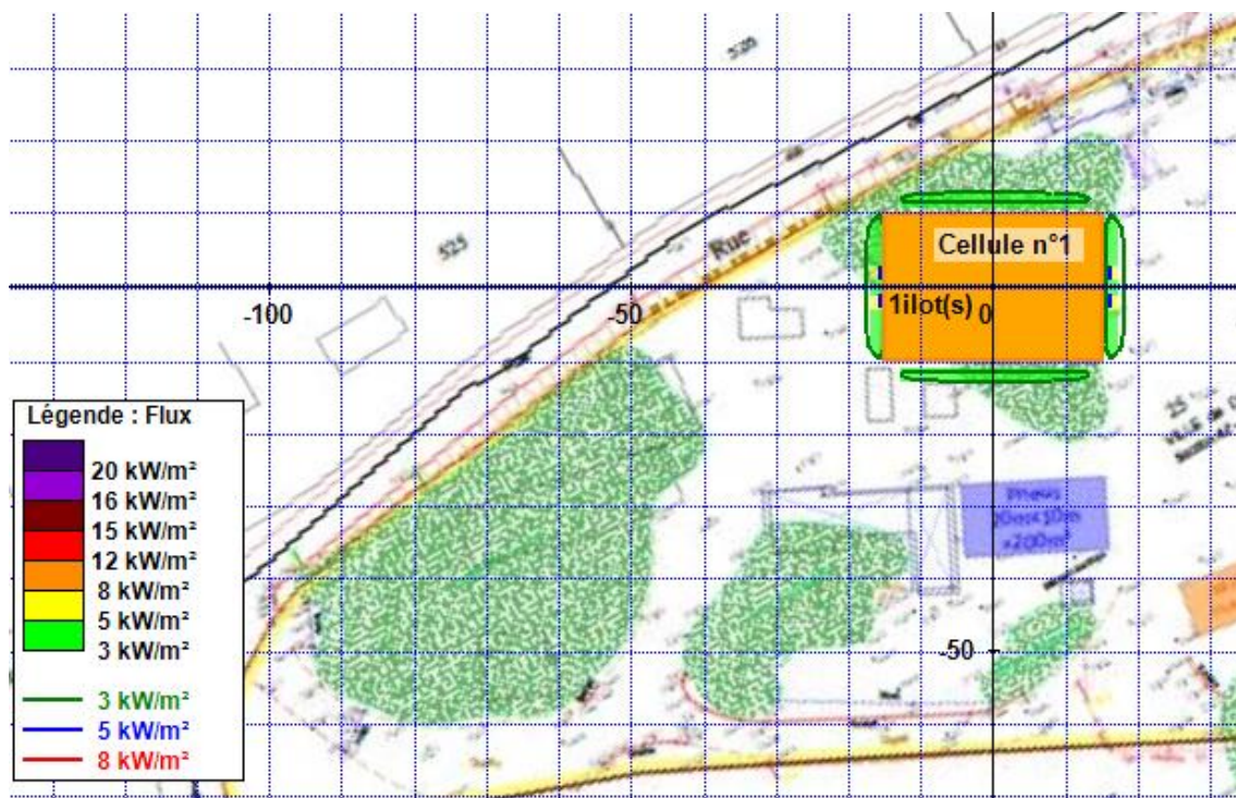
Figure 4 : Représentation sur plan des effets thermiques de la zone de stockage de déchets de balayage scénario 1 – FLUMILOG
